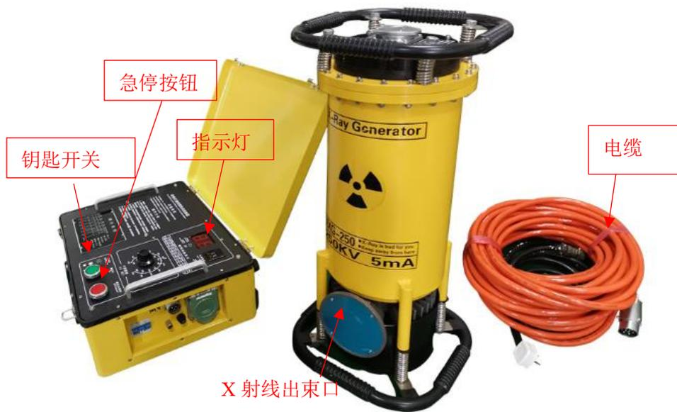
XXG-3005 型 X 射线探伤机构造图
