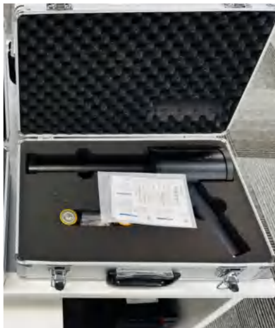
图 3-6.6 便携式剂量率仪
