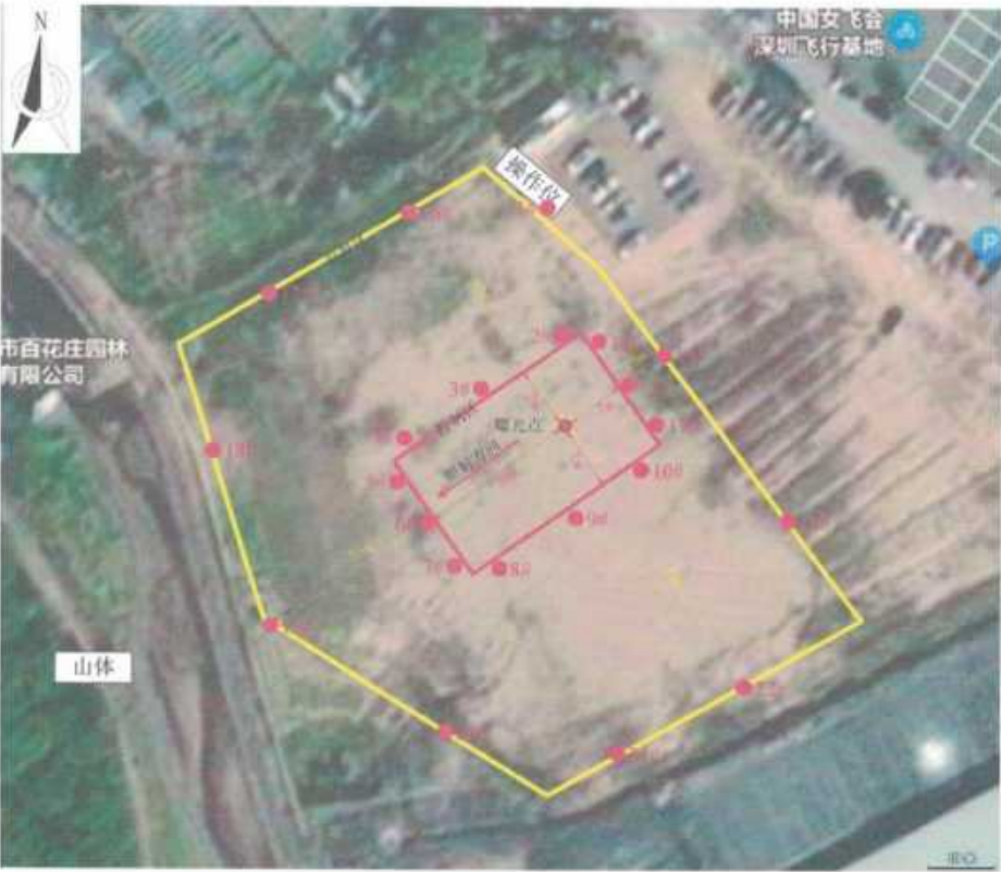
附图 2：移动式探伤检测布点图
