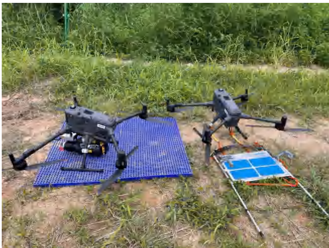
图 2-7 无人机机载探伤装置实物图
