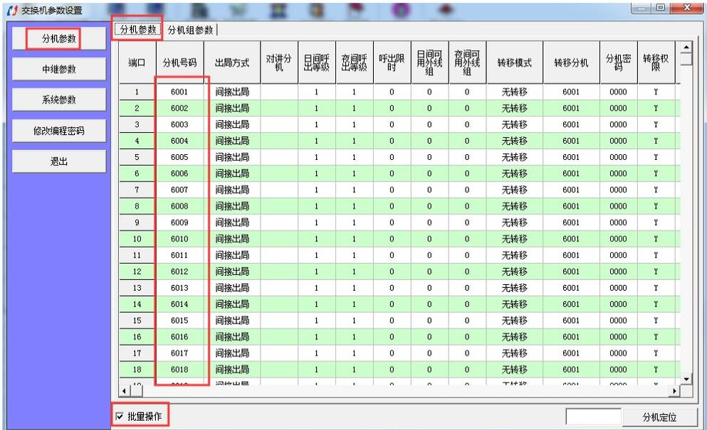
第一列为物理端口，对应分机的物理端口号（1-256），第二列为弹性编码，对应分机号码是 8001-8256。
