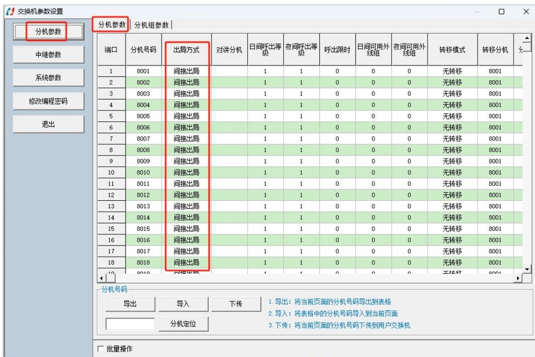
出局方式可以设置为直接出局方式（提机后可以直接拨打外线电话）和间接出局方式（提机后，可以直接拨打内线分机，拨外线需要先拨出局号）。
