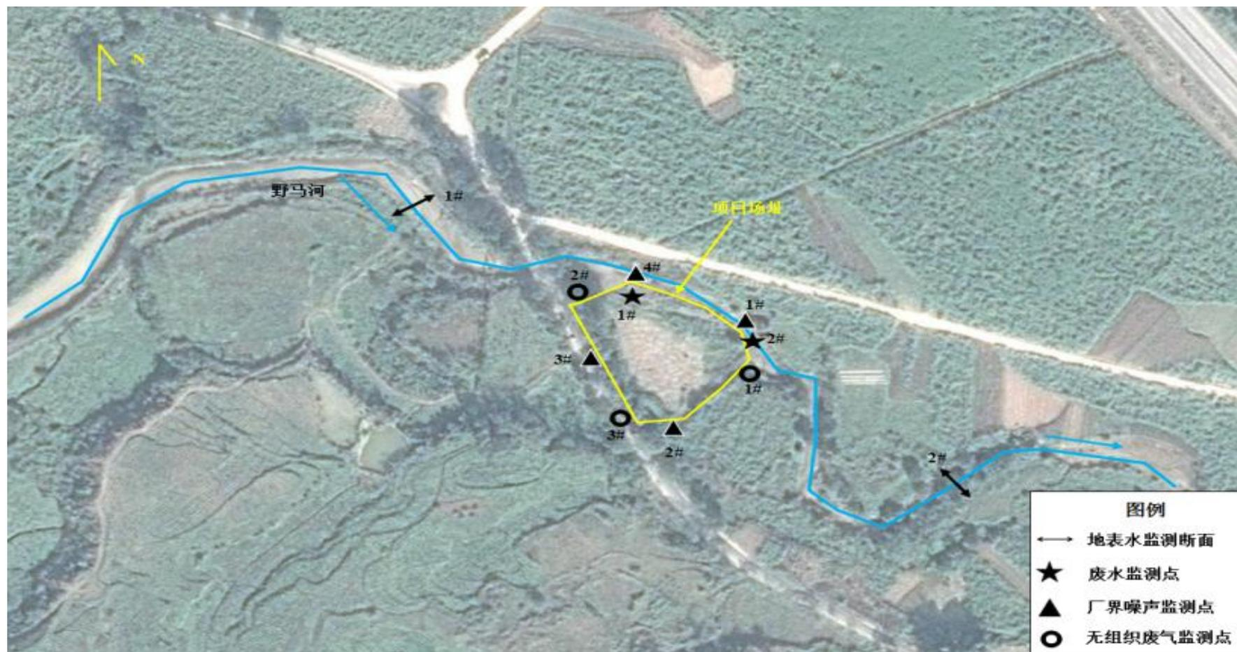
图 6 项目噪声、废水、无组织废气、地表水监测点位示意图
