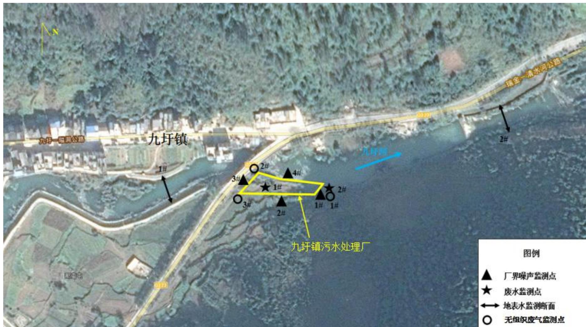
图6 项目噪声、废水、地表水、无组织废气监测点位示意图
