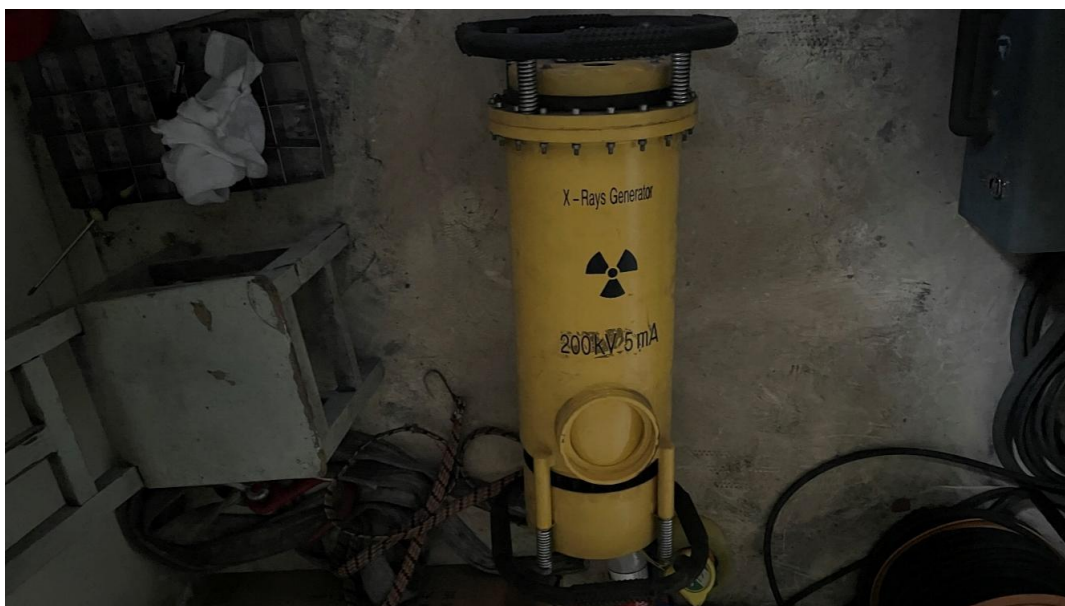
图 9-5 本项目原有 XXQ2005 型 X 射线探伤机外观图
