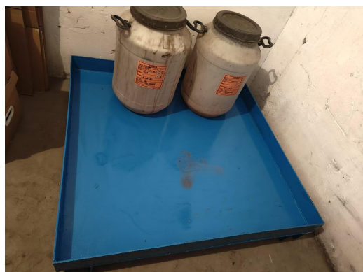
图 15 废显（定）影液、洗片废液收集桶、防渗托盘
