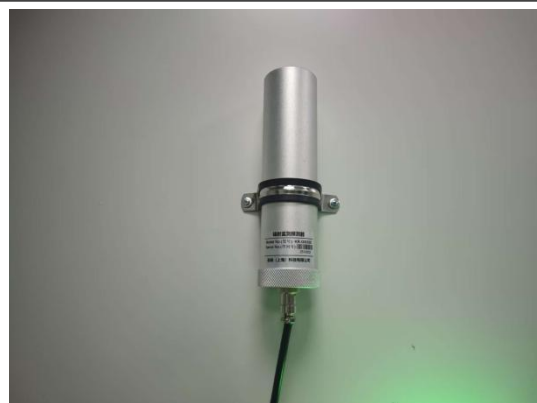
图 13 辐射监测探测器
