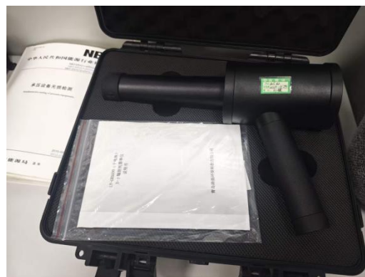
图 16 便携式 X-γ 剂量率仪
