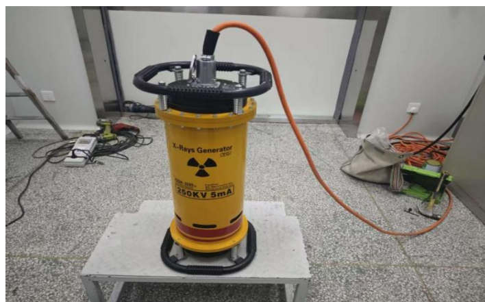
图 2-4 本项目 X 射线探伤机外观图
